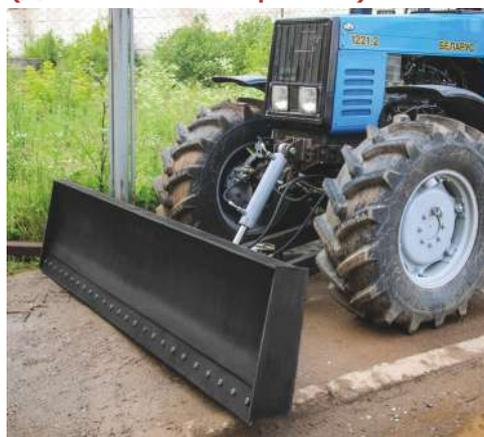
Отвал предназначен для бульдозерных, планировочных и иных земляных работ на грунтах I-II категории.
